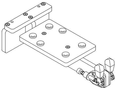
Шаблон для установки механических соединителей коробки
