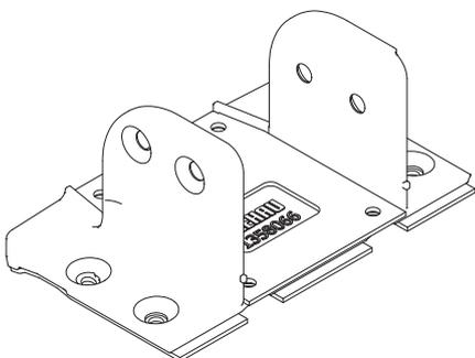
Механический соединитель импоста 96 INTELIO®SLIDE
