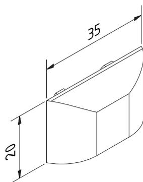
Колпачок водотводного отверстия
